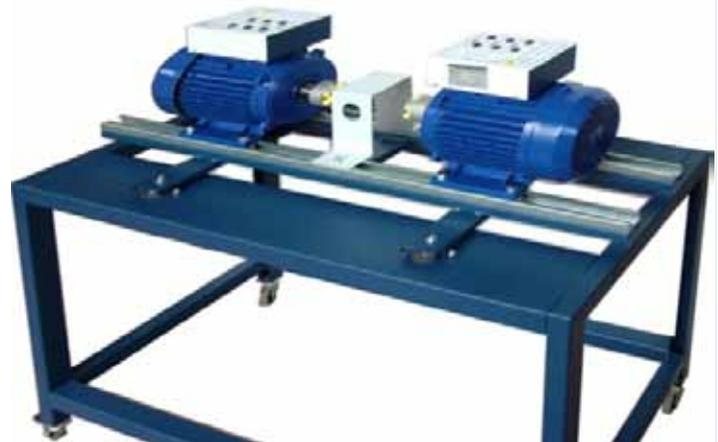
Le groupe est prêt pour être placé à côté du banc qui comprend l'alimentateur de puissance pour effectuer les épreuves. On devra encore placer la protection du couplage et la protection du bout d'arbre libre si quelque machine présente double bout d'arbre.
