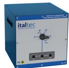
MOD.6018-4R -Régulateur de vitesse pour moteur à bague • Résistance variable de 3x.15.a.100%; • Résistance avec 4 bonds; • Cycle de travail 100%; • Pour moteur 2/4kW
