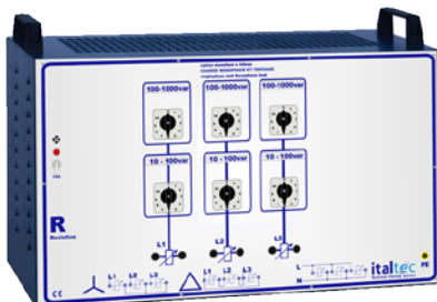
MOD. 6020-R110T Charge résistive pour dynamos et pour alternateur triphasé; Démarrateur pour moteur c.c.; • Résistance variable 3x 1%-110%; • 3-Ph: variable avec 110 pas de régulation de 1% à 110% • Puissance nom.: 30-3300VA;
