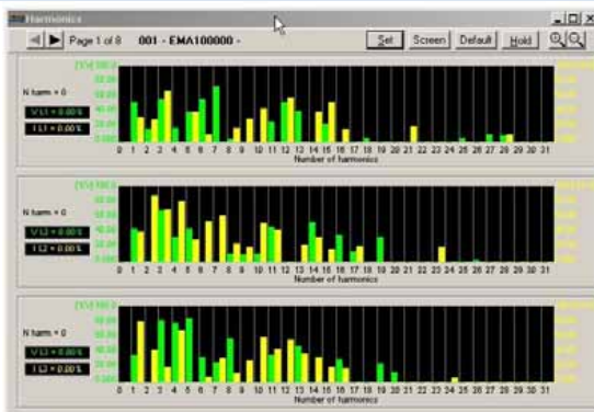
Visualizzazione numerica e grafica delle componenti armoniche di tensione e corrente fino alla 31.ma. (Solo 4209-C)
